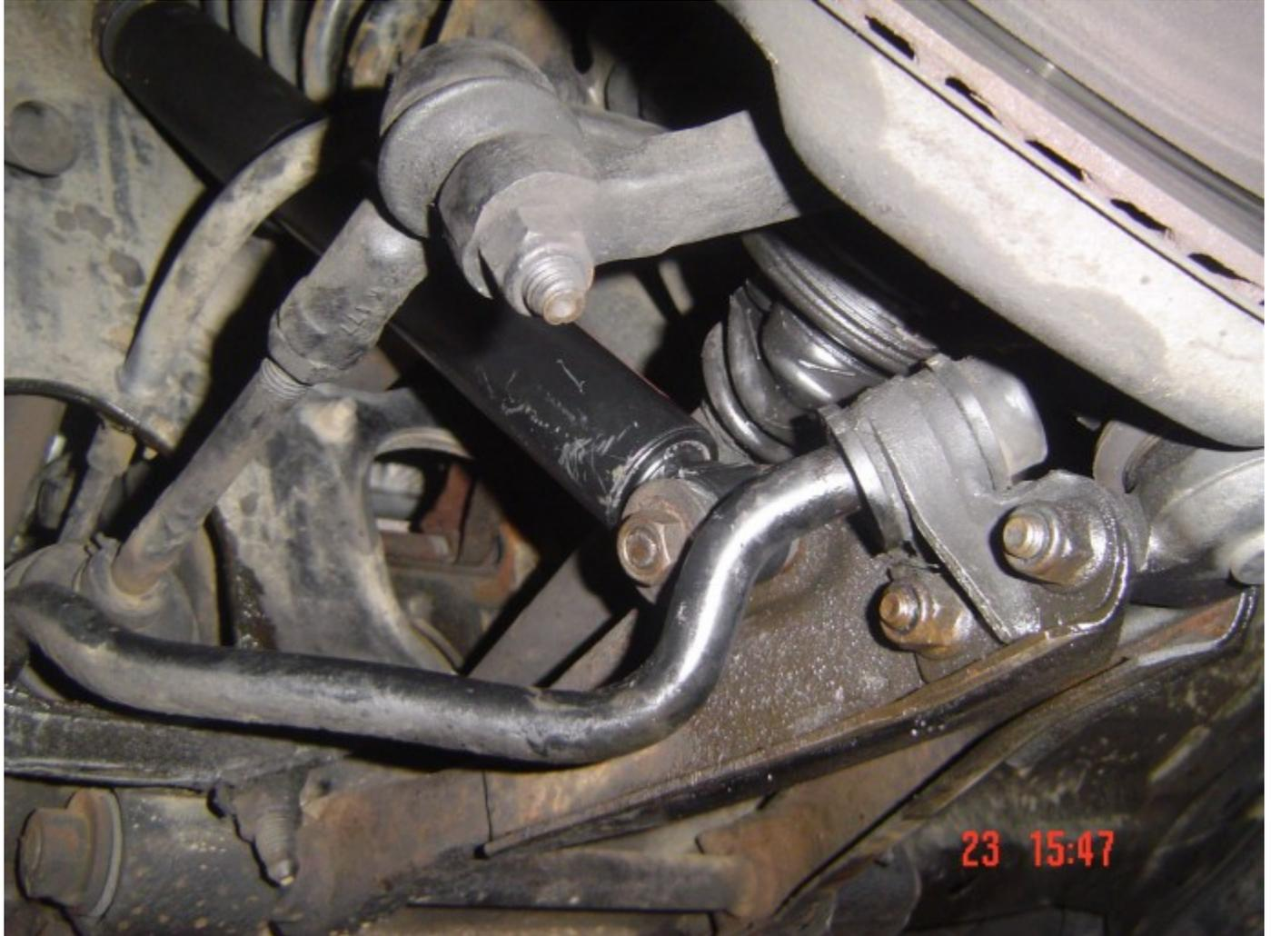
Remettre l'écrou de fixation
