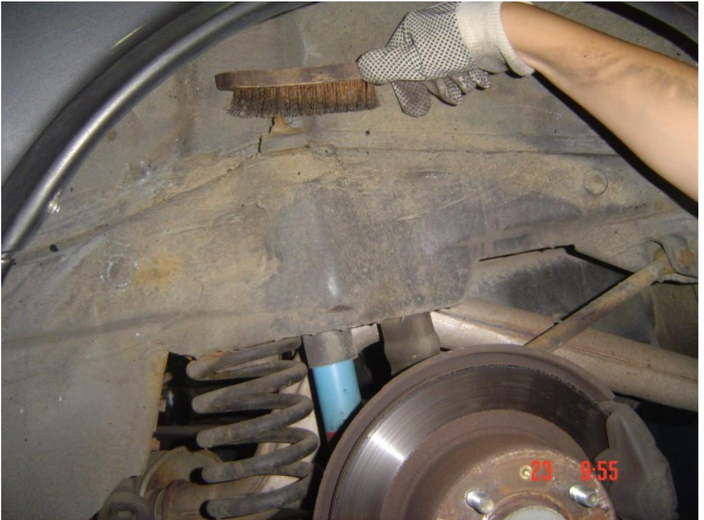
Utiliser une brosse métallique pour frotter la rouille sur la fixation haute de l'amortisseur
