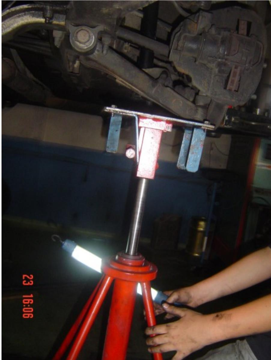
Pour pouvoir remonter la fixation basse, utiliser le pied hydraulique pour faire remonter le bras pivot
