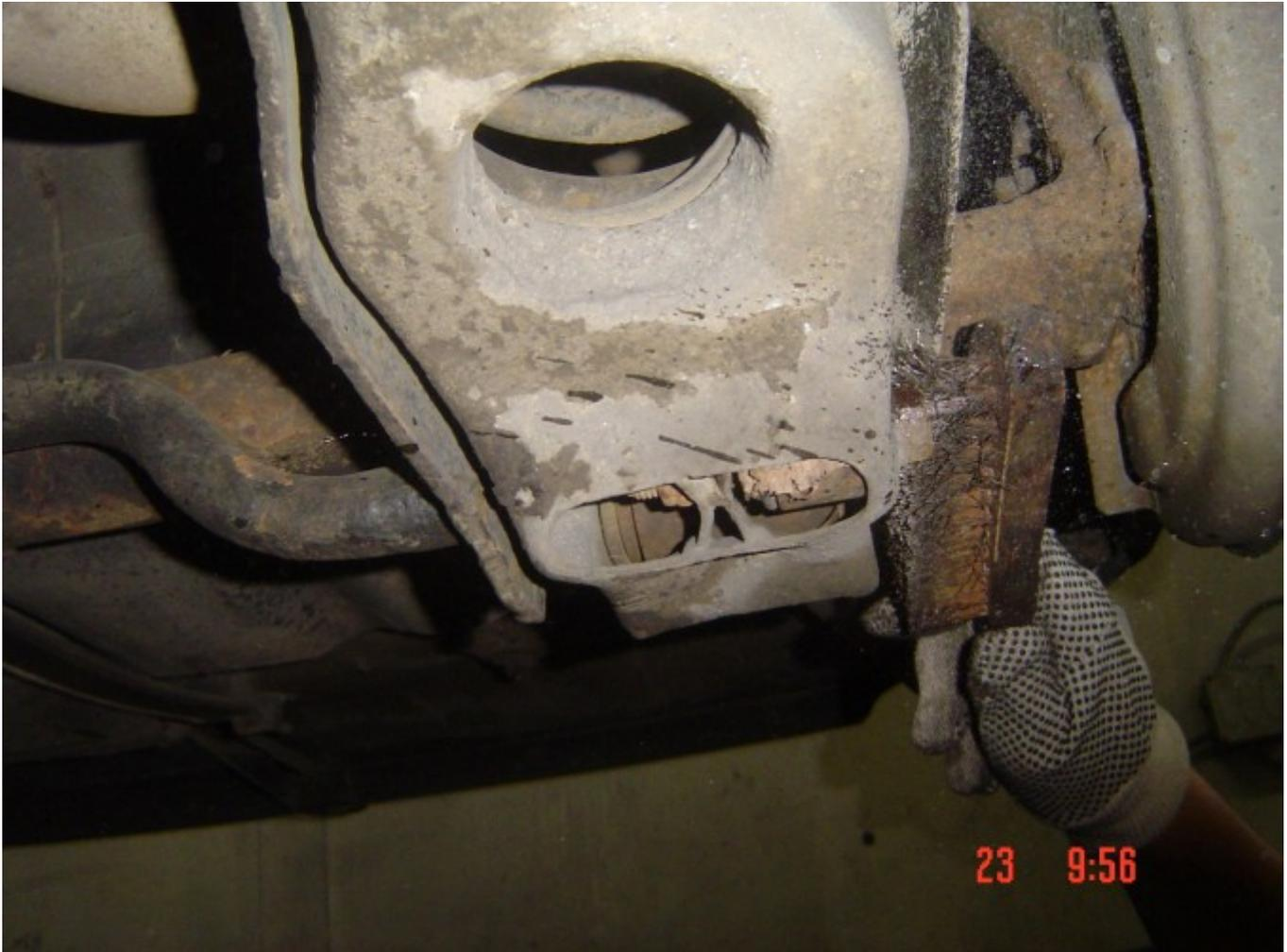
Utiliser une brosse métallique pour frotter la rouille sur la fixation basse de l'amortisseur
